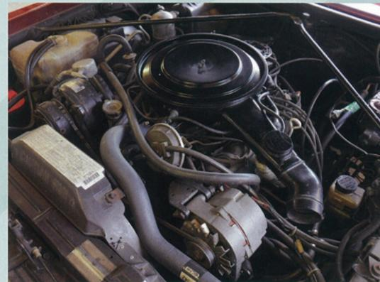
エンジンはオールズモビル製の307cuinV8で圧縮比8.0対1、最高出力140hp@3600rpm、最大トルク240lbft@1600rpm。なお、コンパートメントではエンジンが収納されているが駆動輪は前輪となる。
